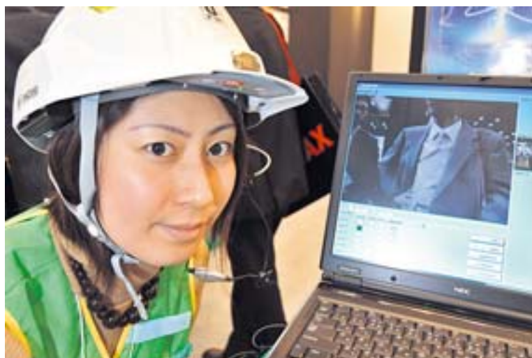
Helm auf: Im weissen «U-met» stecken Webcam, GPS, ein Headset und eine Lampe.
